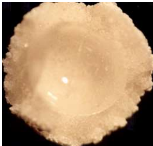
Figura 03: Microscopia da partícula final da reação de polimerização comprovando a formação de estrutura casca-núcleo
