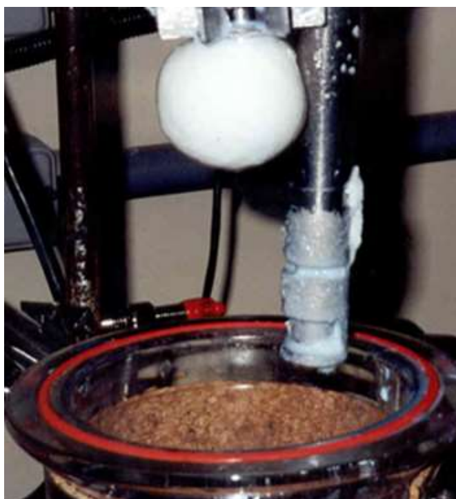
Figura 02: Pedra formada na polimerização
